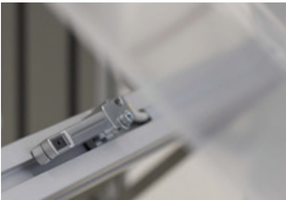
Surveillance et enregistrement permanent de la charge électrostatique dans la production avec iONsense et iONcontrol
